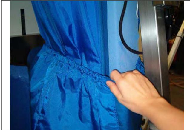
dadurch ausschließlich auf das Kleidungsstück konzentriert wird. Ziehen Sie das Gummiband des Stoffsacks über die beheizte Andruckleiste, um zu garantieren, dass diese perfekt am Kleidungsstück anliegt, siehe Foto 4.4;
