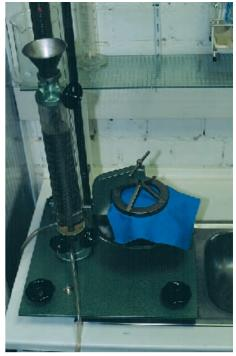
Für die Bestimmung der Öl abweisenden Wirkung hat sich die Anwendung der Prüfmethode der Vereinigung Amerikanischer Textilchemiker und Coloristen, AATCC 188, bewährt. Bei dieser Prüfung werden Lösungen aus unterschiedlichen Mischungsverhältnissen Paraffinöl und N-Heptan auf das imprägnierte Gewebe aufgebracht und die Benetzung ermittelt.
