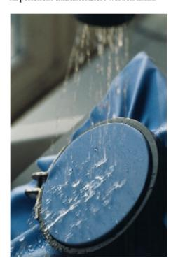
DIN/EN 20811 ist ein hydrostatischer Druckversuch, mit dem die Höhe der Wassersäule bestimmt wird, der ein imprägniertes Textilstück standhält. Diese Prüfung charakterisiert die Wasserdichtigkeit.
