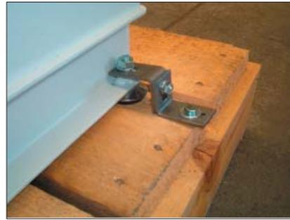
Abbildung 8.1. Befestigung der Maschine an der Palette
